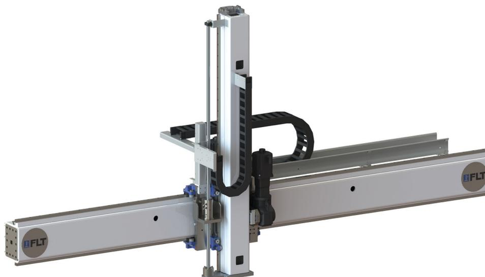
Der LGR-5 ist für Handhabungsgewichte bis 1600 kg ausgelegt, bewältigt Vertikalhübe bis etwa 3 m und erreicht eine Verfahrensgeschwindigkeit bis 3 m/s bei einer Beschleunigung von bis zu 4 m/s<sup>2</sup>.
